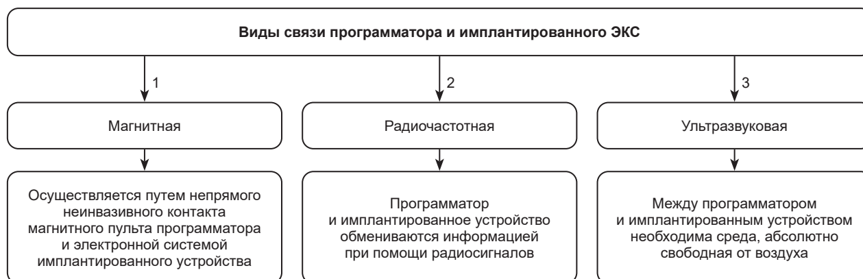
Рис. 2. Виды взаимодействия программатора и имплантированного ЭКС
