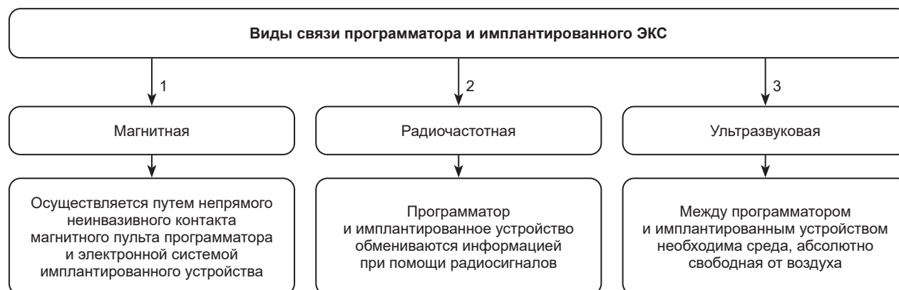
Рис. 2. Виды взаимодействия программатора и имплантированного ЭКС
